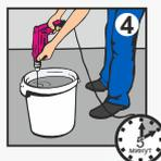
4 Для подготовки раствора залейте водопроводную воду комнатной температуры в чистую емкость из расчета 0,26-0,28 л воды на 1 кг сухой смеси. Засыпая сухую смесь в воду, перемешивайте раствор дрелью со специальной насадкой на низких оборотах до получения однородной массы. Подождите 5 минут, после этого перемешайте вторично. Время пригодности раствора к работе не менее 30 минут.
